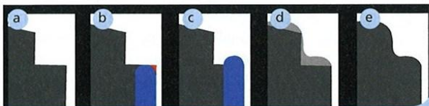
Abb. 5: Schematische Darstellung des Prinzips der Fräserradiuskorrektur: a) zu fertigende Geometrie (weiß), b) Werkzeug (blau) und nicht zugängliches Restmaterial (rot), c) notwendige zusätzliche Eindringtiefe, d) Fräserradiuskorrektur (hellgrau), e) Schleifergebnis nach vollständiger Bearbeitung.
